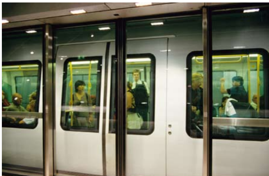
Dörrar mellan spår och perrong finns på många ställen i världen, här på bilden i Köpenhamn. Att hamna framför tunnelbanan är en av de främsta dödsorsakerna för ungdomar i Stockholm.
