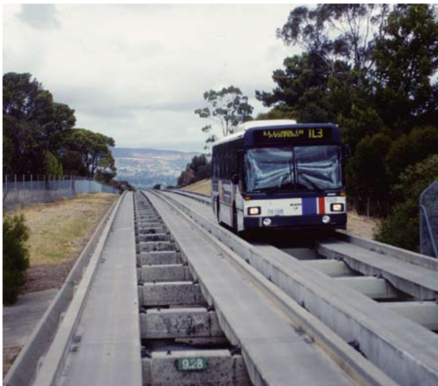
Buss på spår från Adelaide. Bussen styrs med ett litet hjul mot kanten varför spåret kan ta mycket liten plats.
