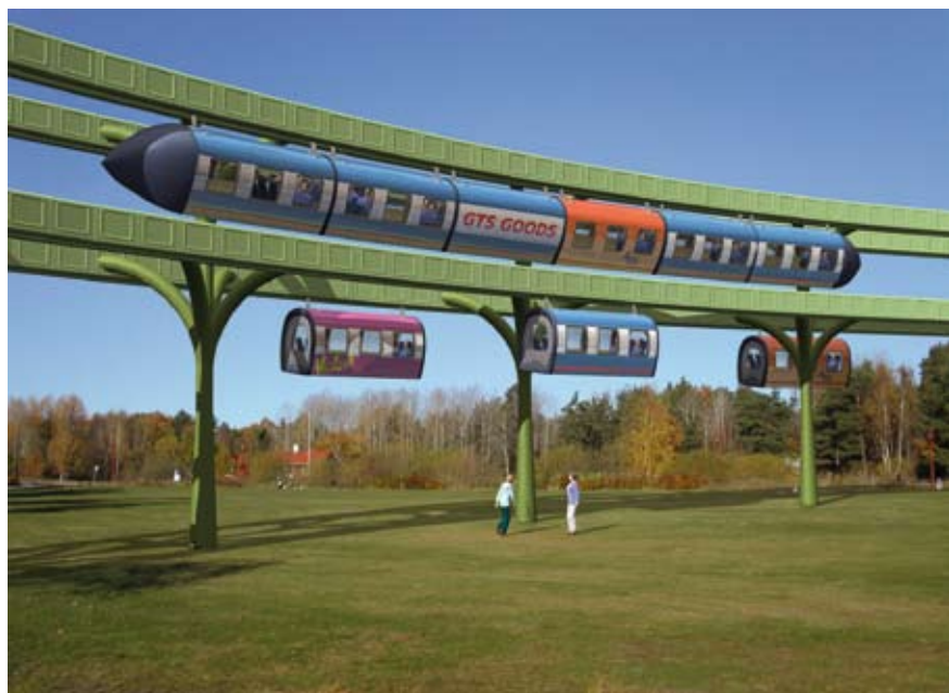
Små och lite större fordon kan samsas på samma banor. De större i första hand för linjebundna resor, de mindre – när sådana finns att tillgå – för individuellt styrda. Bild Hans Kylberg.
